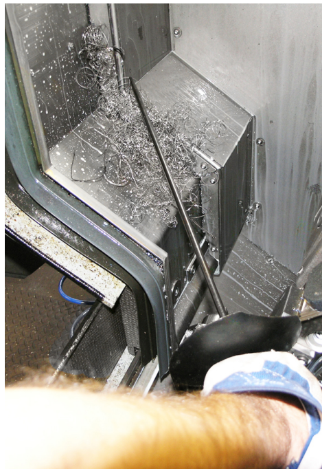
Beispiel: 1 Entfernen der Spänenester mit Hilfe geeigneter Werkzeuge (z.B. Spänehooken)
