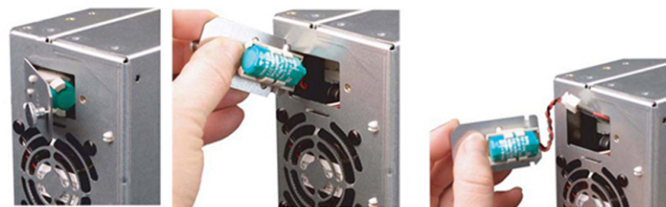
Beispiel: Batterietausch PCU 50.3
