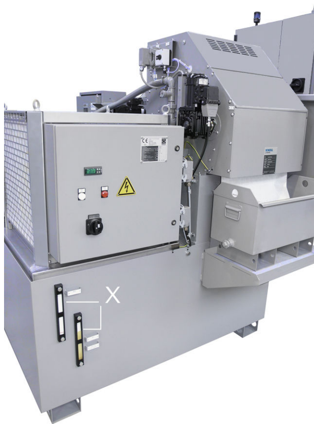
Füllstandsanzeige an einer Kühlschmierstoff-Aufbereitungsanlage (Fa. Knoll)
