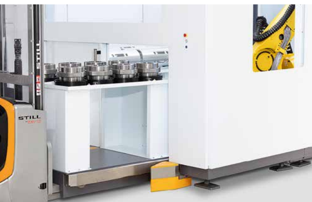
Die Palette mit den Werkstücken wird in die Automationszelle eingeschoben.
